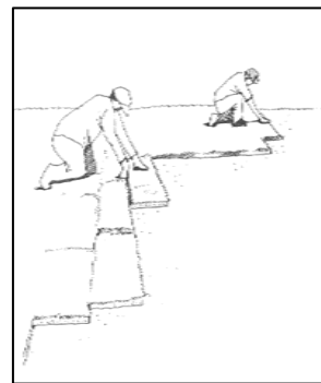
Kaedah penanaman rumput secara hamparan ( Close Turfing ) secara bergulung dan secara kepingan sod.
